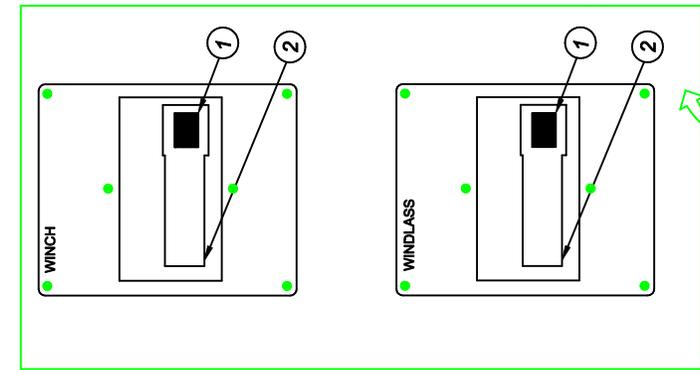
1. (TEST) ON/OFF BUTTON, PUSH TO TRIP RESET
