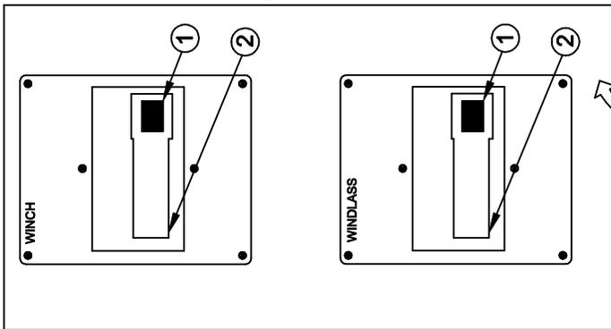
1. (TEST) ON/OFF BUTTON, PUSH TO TRIP RESET
